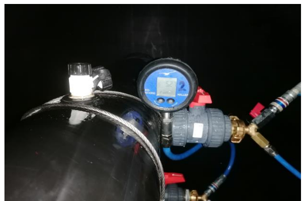
Langzeit-Abschlussdruckprüfung über fünf Tage
