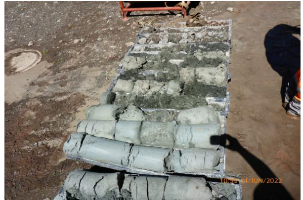
An hand der Bohrkerns wird der Brunnenausbau festgelegt
