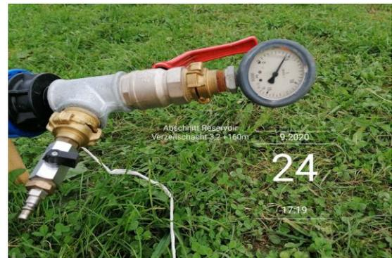
Langzeit-Druckprüfung mit Durchflussmessung. Abschlussprüfung und Übergabe an die Bauherrschaft.
