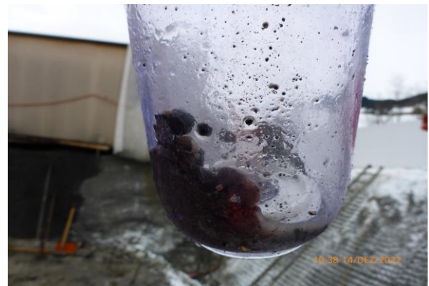
Zum Teil starke Verschmutzung im Sondeninnern durch Sand, Kies und Klebebandreste
