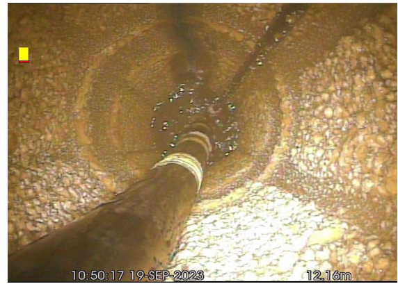
Sehr stark verunreinigte Brunnenrohre mit extremer Verkrustung im Schlitzbereich
